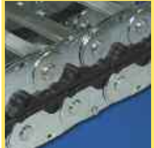
图A 拖链可以通过弯曲段的内侧或者外侧进行固定。
