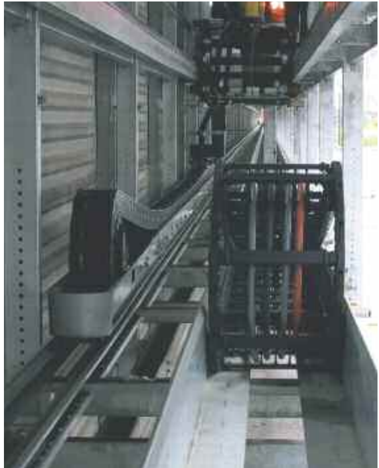
长行程拖链试验台：130米行程上的测试速度为8米/分
