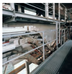
Catena tipo 310 e 40 che equipaggiano il ponte "Oresund" che collega Svezia e Danimarca.
