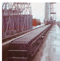
Catena tipo 35 con carro di supporto applicata su impianto di De Icing presso l'aeroporto di Monaco di Baviera.
