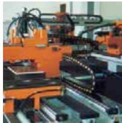
Chaînes en nylon de la série Heavy montées sur des machines-outils.
