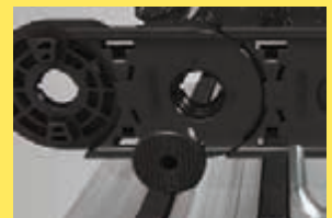
Extraction de l'axe de jonction avec une clé Allen.
