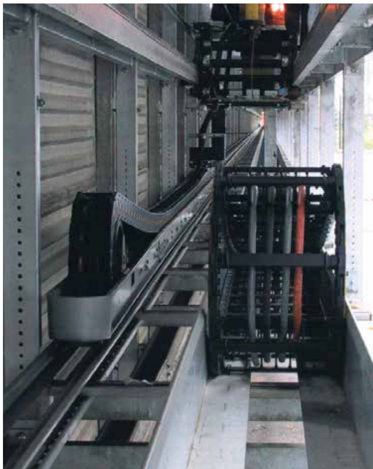
Système essai pour chaînes longue-course Longueur course 130 mètres Vitesse 8 m/s
