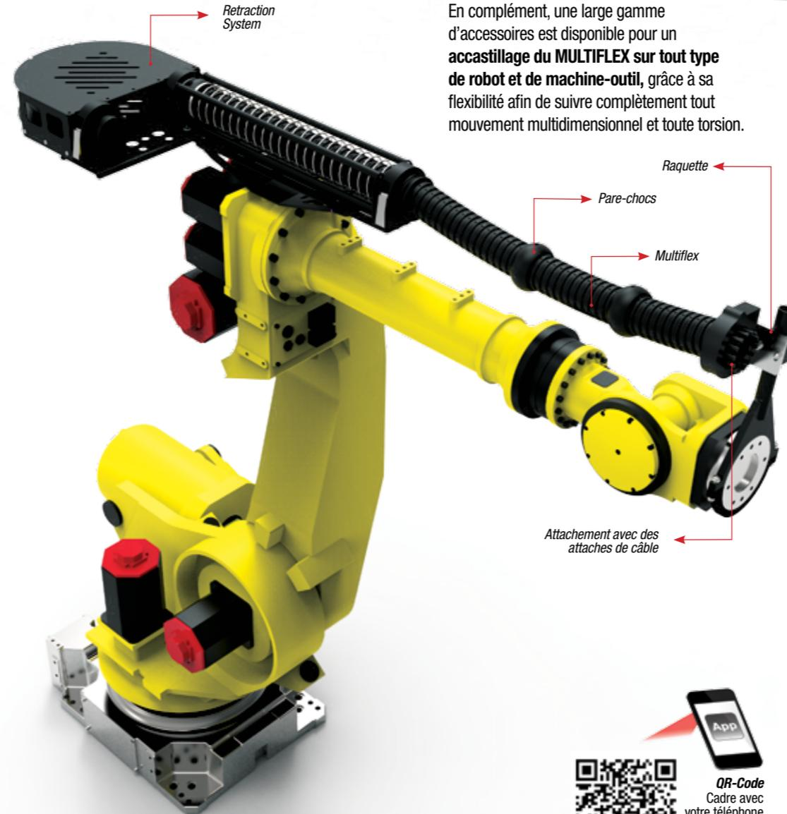
En complément, une large gamme d'accessoires est disponible pour un accastillage du MULTIFLEX sur tout type de robot et de machine-outil, grâce à sa flexibilité afin de suivre complètement tout mouvement multidimensionnel et toute torsion.
